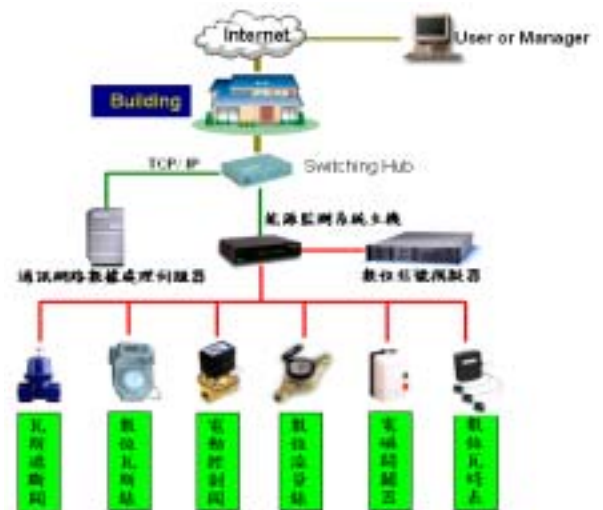
圖 2 建築物能源監測模擬系統架構圖(單戶型)
