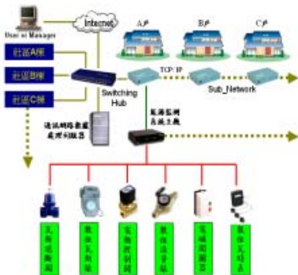
圖 3 建築物能源監測模擬系統架構圖(社區型)
